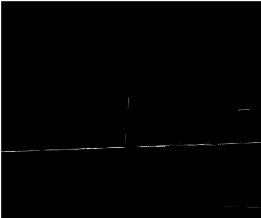
水平Sobel二值化後霍夫法取線段
