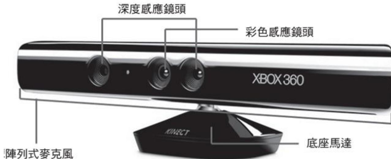
圖15.2.1 體感操控器 Kinect
